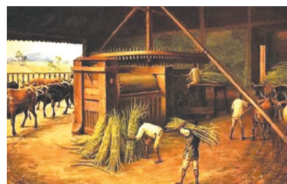
A ilustração do início do século XIX, de Hercules Florence, mostra o mecanismo da máquina de moer cana, que era movimentado pelos bois atrelados à grande alavanca.
