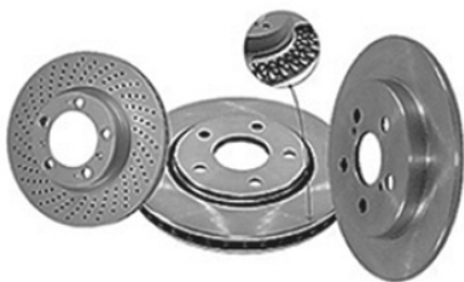
Da esquerda para a direita: perfurado, ventilado e sólido. (No detalhe, a câmara interna do disco ventilado).
