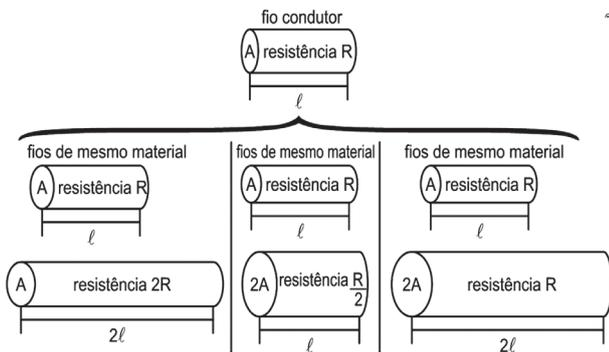
As figuras mostram que as proporcionalidades existentes entre resistência ( $R$ ) e comprimento ( $\ell$ ), resistência ( $R$ ) e área da secção transversal ( $A$ ), e entre comprimento ( $\ell$ ) e área da secção transversal ( $A$ ) são, respectivamente:
