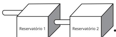
A água entra no sistema pelo cano de entrada no Reservatório 1 a uma vazão constante e, ao atingir o nível do cano de ligação, passa a abastecer o Reservatório 2. Suponha que, inicialmente, os dois reservatórios estejam vazios.
